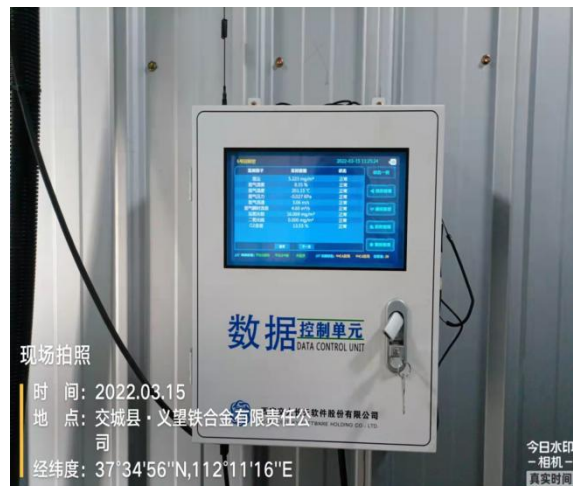
6#锰矿烘干回转窑在线数控单元
